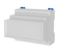
Шестимодульный пластмассовый корпус (106 мм в ширину) для электронной аппаратуры, способ сборки без винтовой (на защёлках). Материал корпуса ABS пластик. Возможно крепление корпуса на Din рейку (35мм) или на ровную поверхность. Отдельно поставляется пломбировачная крышка.
