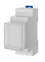
Двухмодульный пластмассовый корпус (35 мм в ширину) для электронной аппаратуры, способ сборки без винтовой (на защёлках). Материал корпуса ABS пластик. Возможно крепление корпуса на Din рейку (35мм) или на ровную поверхность. Отдельно поставляется пломбировачная крышка.
