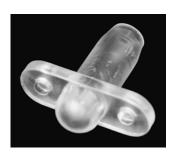
Миниатюрный корпус для размещения фотоэлементов и т.д. Материал прозрачный и прочный поликарбонад с отверстиями для крепления. Крепление на ровную поверхность. Диаметр корпуса 10 мм, расстояние между центрами крепежных отверстий 20мм, под винты М3.
