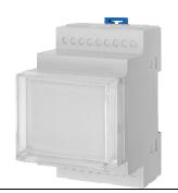
Трехмодульный пластмассовый корпус (53 мм в ширину) для электронной аппаратуры, способ сборки без винтовой (на защёлках). Материал корпуса ABS пластик. Возможно крепление корпуса на Din рейку (35мм) или на ровную поверхность. Отдельно поставляется пломбировачная крышка.
